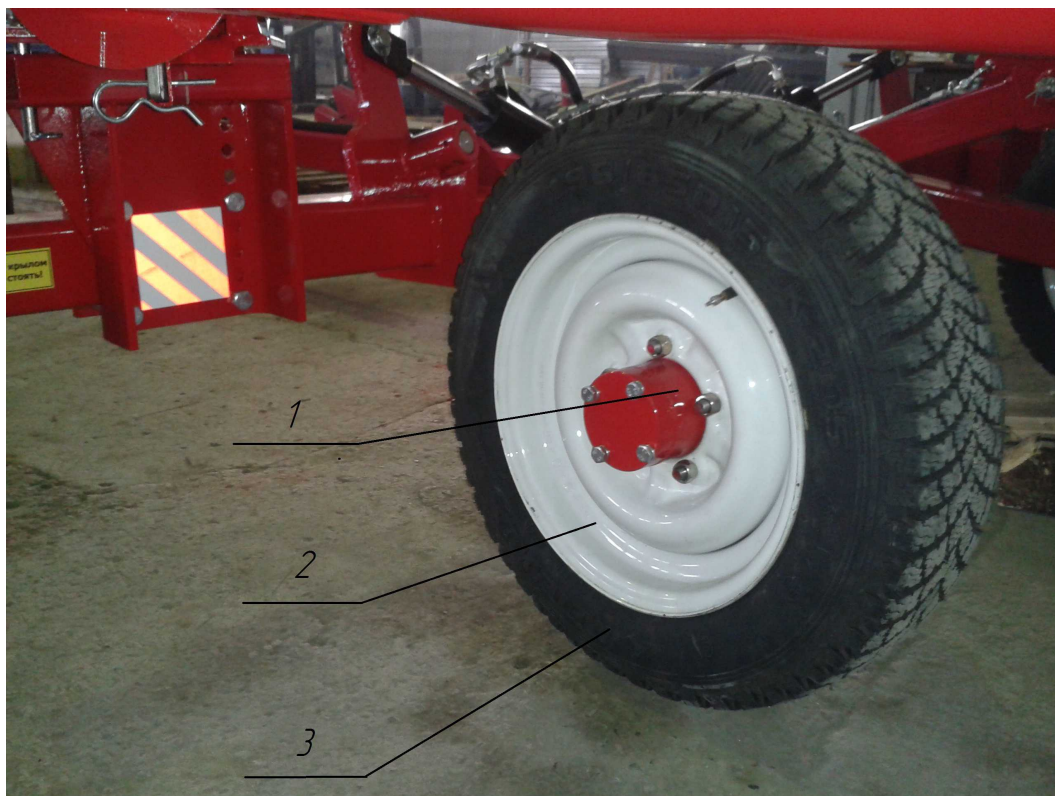
Рис. 3.5 - Колесо транспортное 1 — Ступица УАЗ, 2 — Диск 15" УАЗ, 3 — Шина 195/65/R15
