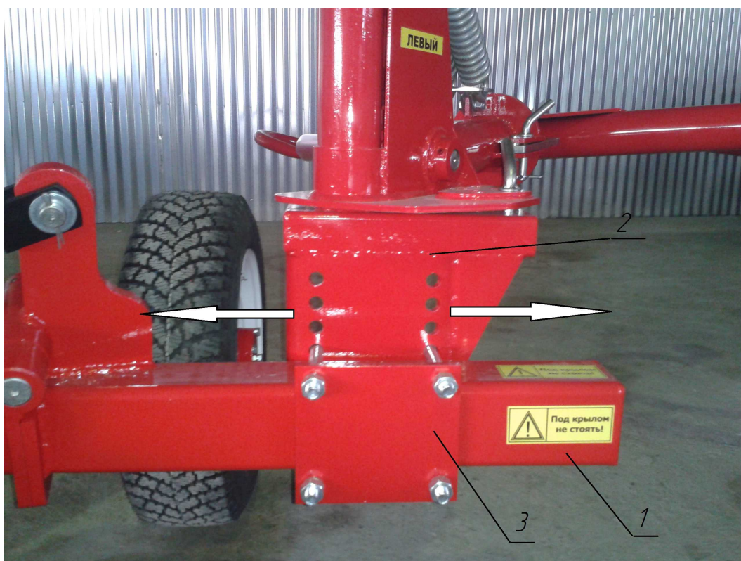
Рис. 3.8 — Дополнительная регулировка ширины валка 1 — Балка, 2 — Кронштейн, 3 — Пластина
