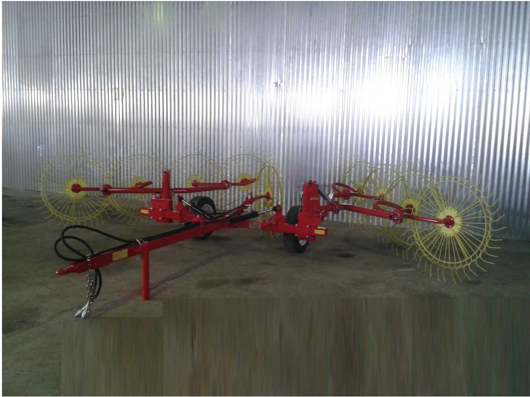
Рис. 3.3 - Установка секций граблей на сгребание
