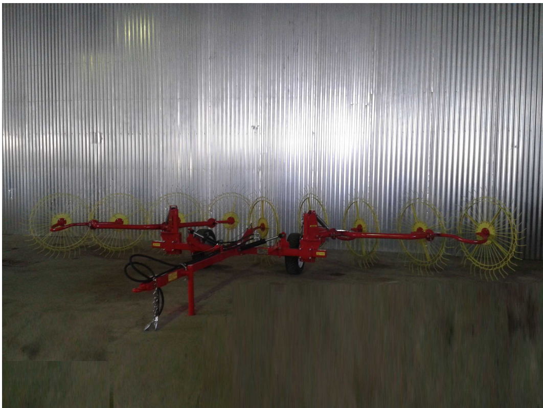
Рис. 3.4 - Установка секций граблей на ворошение
